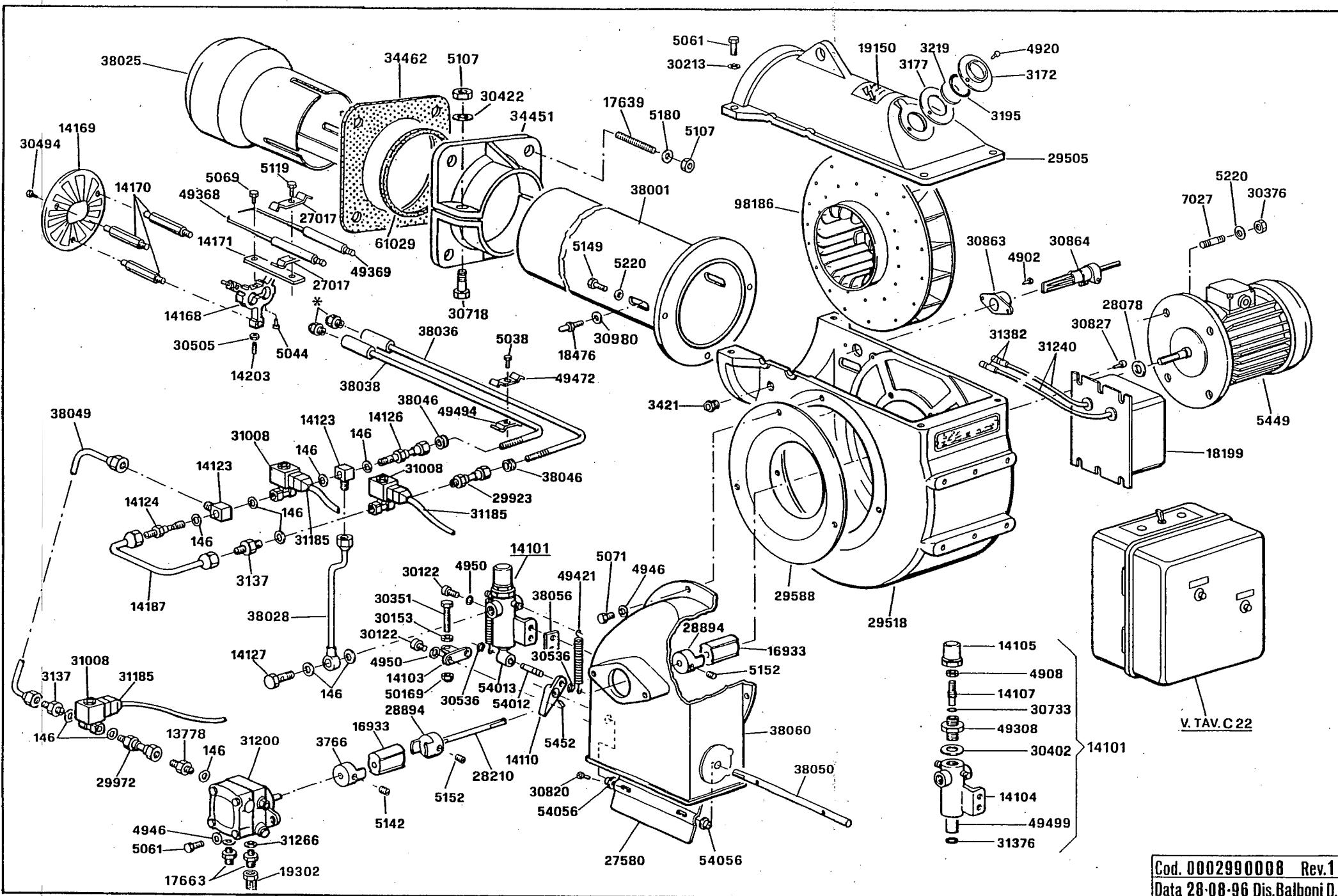
R38055 - APPARECCHIATURA - CONTROL PANEL - APPAREILLAGE ELECTRIQUE - SCHALTGERAETE
